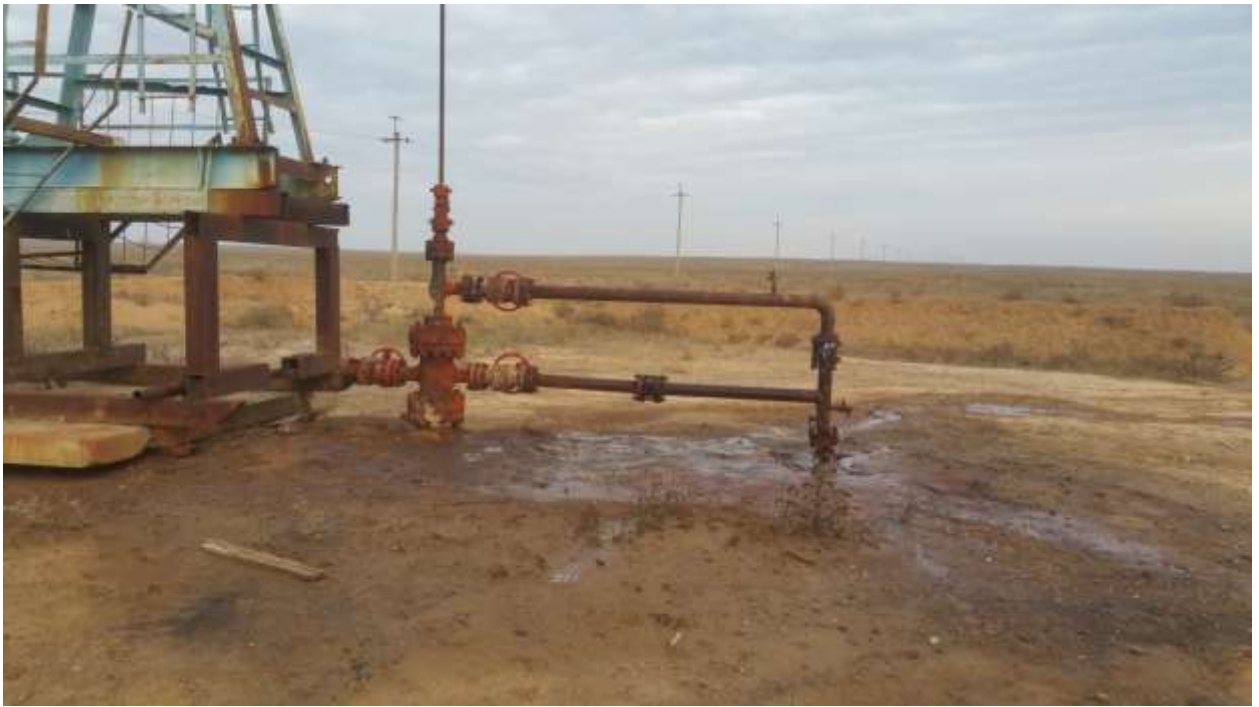
Рис. 3.2.4. Разгерметизированная нефтяная скважина Надеждинского месторождения
